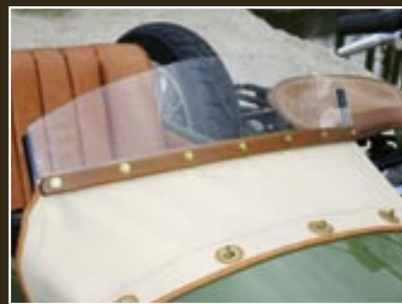
Die Frontschürze ist aus hochwertigem Verdeckstoff gefertigt. Viel Mühe gab sich die Firma Kirschbaum beim Einfassen von Rändern und Ösen mit braunem Kunstleder.
