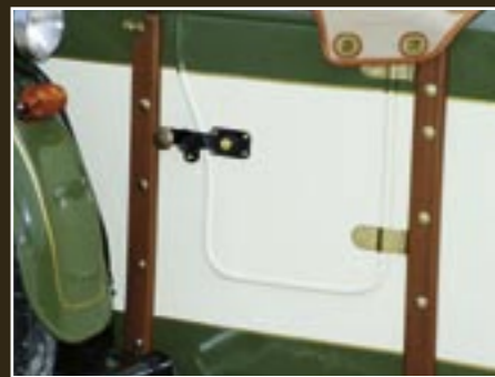
Die Holzleisten stabilisieren mit dem innenliegenden Flacheisenrahmen das Boot. In erster Linie dienen sie aber der Zierde.
